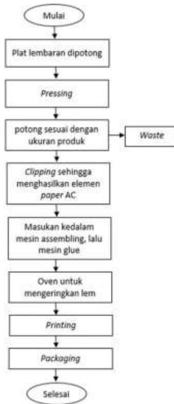
Gambar 1. *Flow Chart* Pembuatan *Air Filter*
